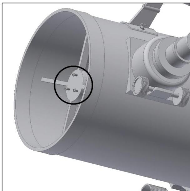
Abb. 25. Einstellschrauben des Sekundärspiegels.
